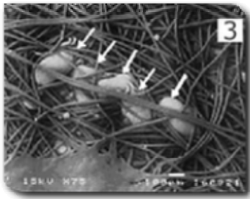
Foto 3: gruppo di acari penetrati e intrappolati nella struttura di una copertura in TNT (ingrandimento x 75)
